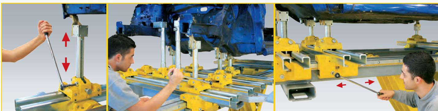
Sistema di tiro in alto, in basso e spostamento traverse, mediante sistema ad ingranaggio e cremagliera. / *Upward and downward pulling system and possibility to move the cross members with rack and pinion system.*
