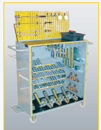
Carrello portaccessori per dima universale Superstar e per sistema di misura Mc Pherson.
