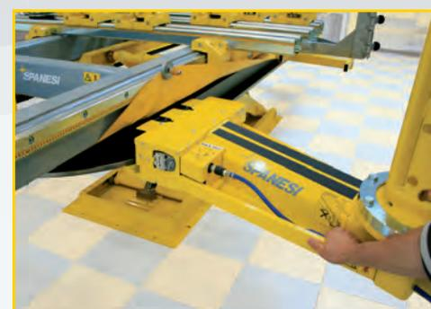
Il bloccaggio del puntone di tiro è di tipo pneumatico.
