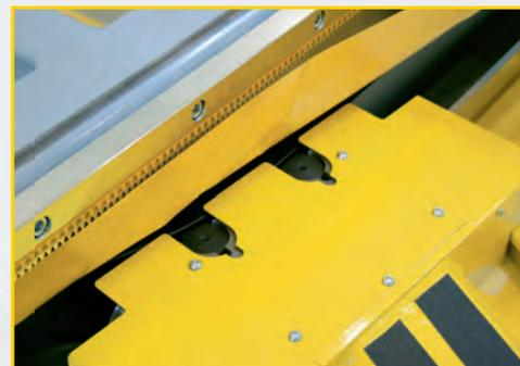
Il fissaggio avviene in qualsiasi posizione attorno al banco.
